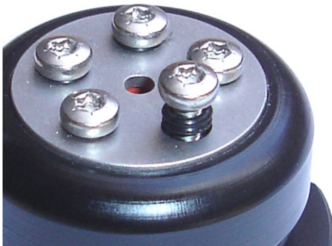
Abbildung 2.5: Schraube mit zwei O-Ringe in Einbaulage
